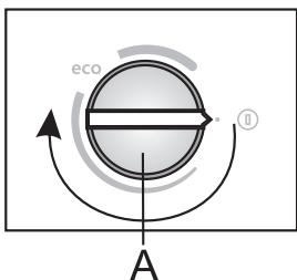
**Pour mettre l'appareil en marche,** tournez le bouton **A** dans le sens des aiguilles d'une montre.
