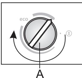
Si la température de la pièce dans laquelle l'appareil est installé est inférieure à 16°C, nous vous recommandons de régler le bouton du thermostat **A** vers la **partie plus large du symbole**.
